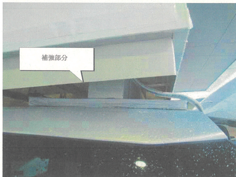
市販のルーフキャリア後方下部に自作した土台を補強している。 (車両後部を接写)
