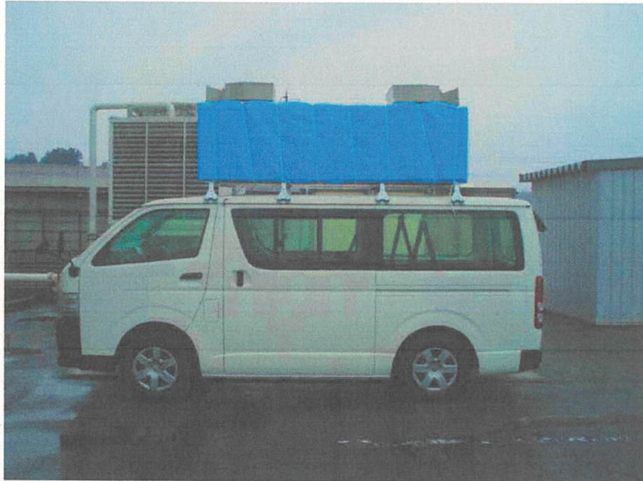
市販のルーフキャリアの積載部分に看板を取付けている。
